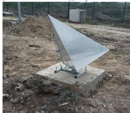
Монтиран реализиран тристенен отражател от нулевата серия
