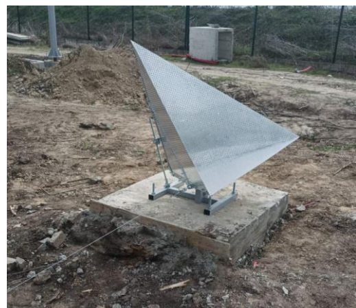
Монтиран реализиран тристенен отражател от нулевата серия
